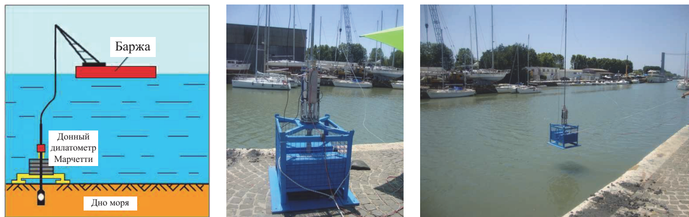
Рис. 11. Дилатометр для выполнения испытаний DMT или SDMT с дна моря
