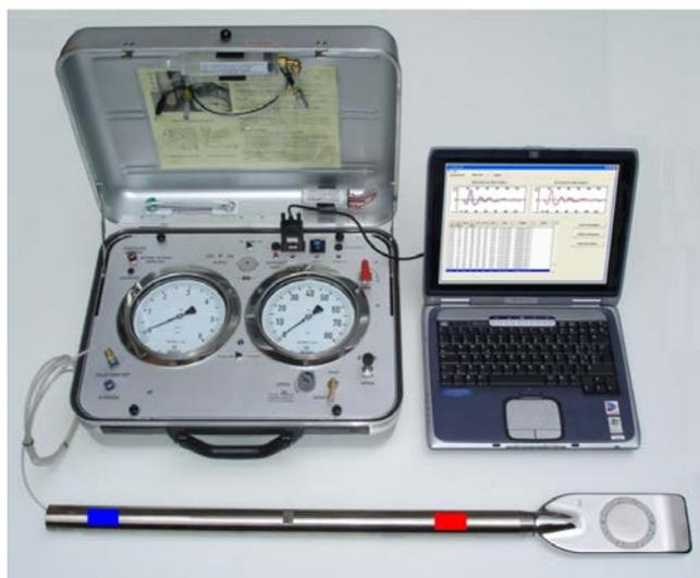
Figure 1. Vue des principaux éléments du SDMT. En bas la dernière tige avec la sonde S à gauche, la lame de la sonde DMT et sa membrane déformable à droite
