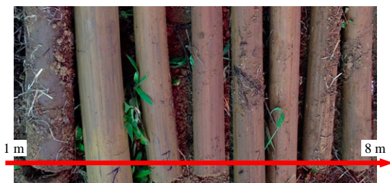
图 1 南阳原位试验场地土层岩芯
